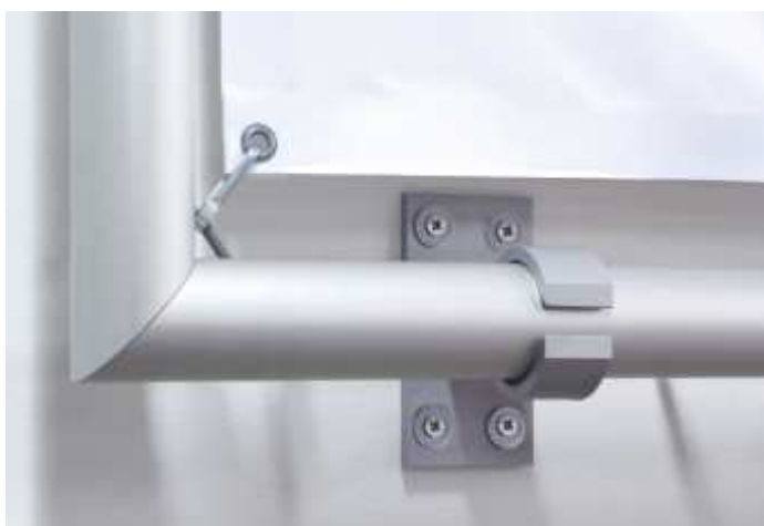
Wandhalter Alu-Klammer, 80 mm Wandabstand, Sockelplatte 80 x 120 mm
